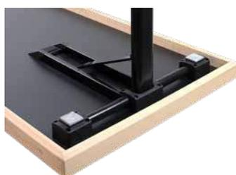
Direktschließendes Kräftedreieck, wartungsfreier Klappbeschlag mit automatisch hochfahrendem Stapelklotz bei Tischen unter 1.520 mm Länge. Durch die achsiale Aufnahme des Tischbeins am Drehpunkt besteht beim Klappen keine Klemmgefahr.
